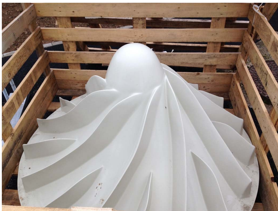
Station d'épuration de Molsheim Exemple de turbine remplacée
